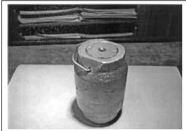
Bleibehälter für eine Cäsium-137-Quelle.
